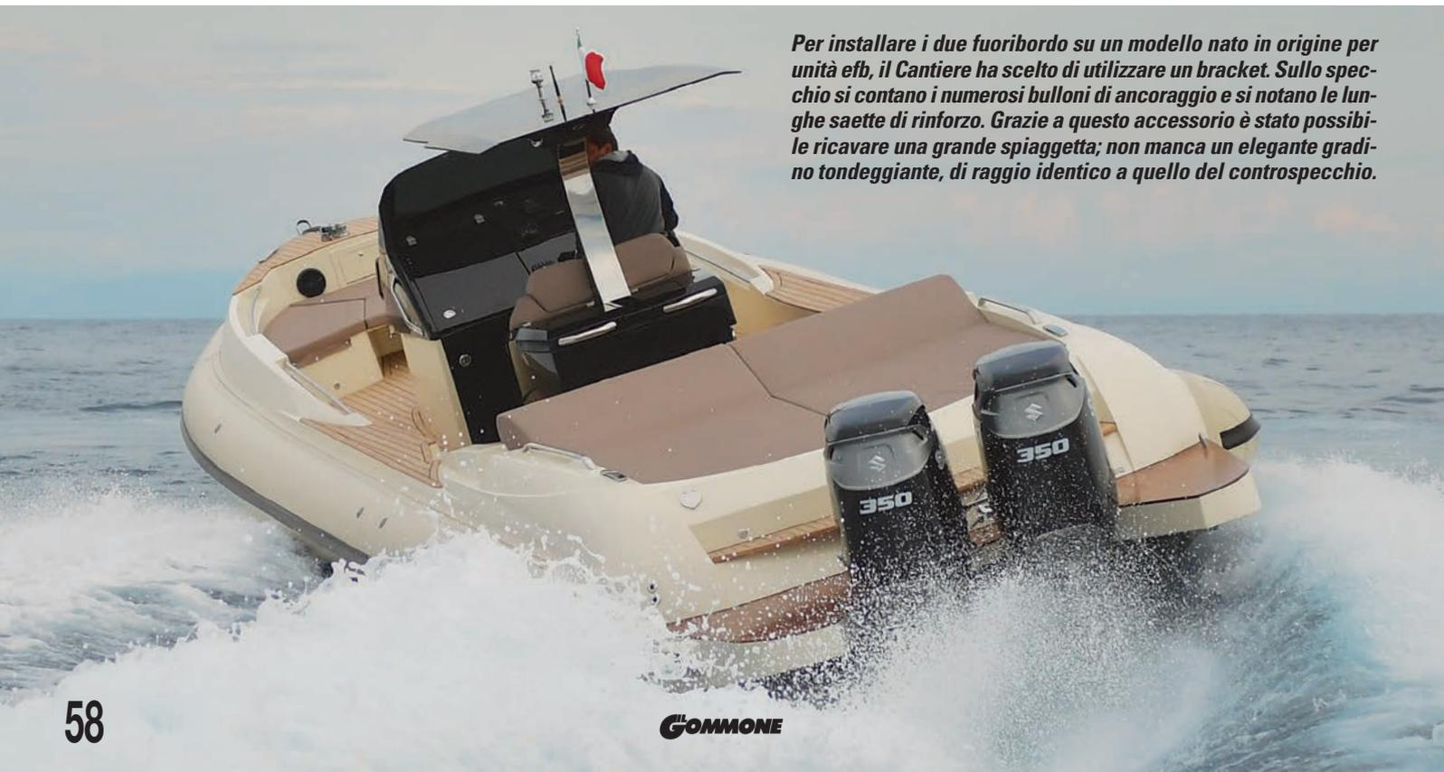
**Per installare i due fuoribordo su un modello nato in origine per unità efb, il Cantiere ha scelto di utilizzare un bracket. Sullo specchio si contano i numerosi bulloni di ancoraggio e si notano le lunghe saette di rinforzo. Grazie a questo accessorio è stato possibile ricavare una grande spiaggia; non manca un elegante gradino tondeggiate, di raggio identico a quello del controspecchio.**
