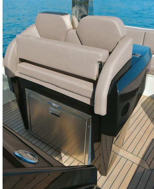
**Il divanetto di pilotaggio si fa apprezzare per gli schienali e le spalline adeguati alle prestazioni. Una porzione del sedile si ribalta per pilotare seduti o appoggiati. Sotto, nella base, c'è un grande frigo a cassetto. Il top della cucina è più largo della sua base e in questo modo risulta più spazioso e comodo.**
