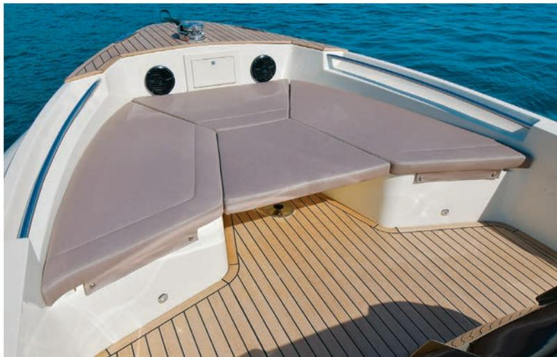
*La delfiniera larga svolge perfettamente il ruolo di area d'imbarco, nonostante la catena dell'ancora sia esposta. Le galloce sono a scomparsa e correttamente posizionate. Un portello, in verità non molto ampio, consente l'accesso al pozzo.*
